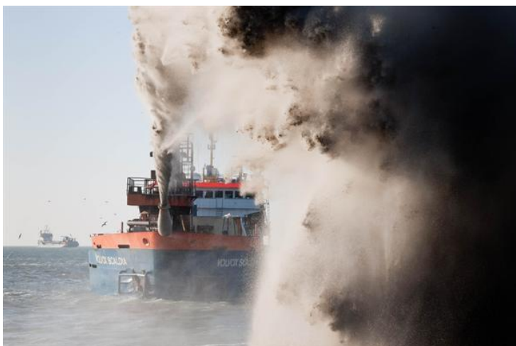
Figuur 3.10 Cutterzuiger Volvox Scaldia zand opspuitend. Bron: beeldbank Rijkswaterstaat.
