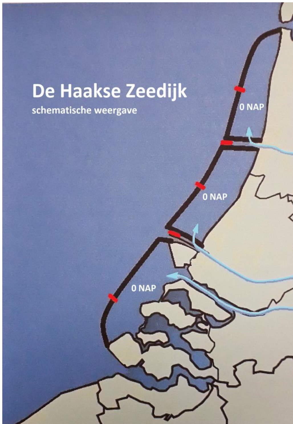
Figuur 25: Schematische weergave van De Haakse Zeedijk. Samenwerken met de ondiepe Noordzee en de zandaanvoerende stromingen vormt de basis van deze nieuwe kustlijn. Bron: Adviesgroep De Haakse Zeedijk
