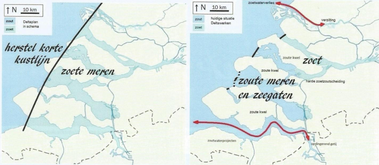
Het principe van het oorspronkelijke Deltaplan en de situatie na de Deltawerken.
